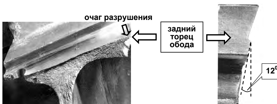
Рис.11. Расположение очагов и поверхности разрушения дисков
