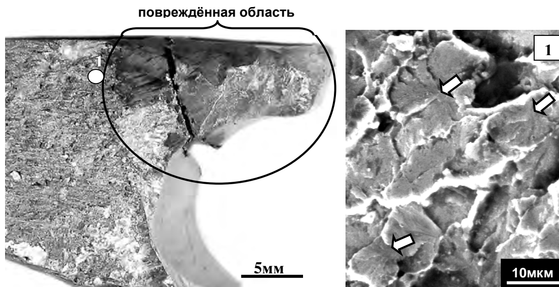
Рис.7. Диск 2: повреждённая область у заднего торца обода и микрорельеф излома за границей повреждённой зоны (стрелки – локальные направления роста трещины)
