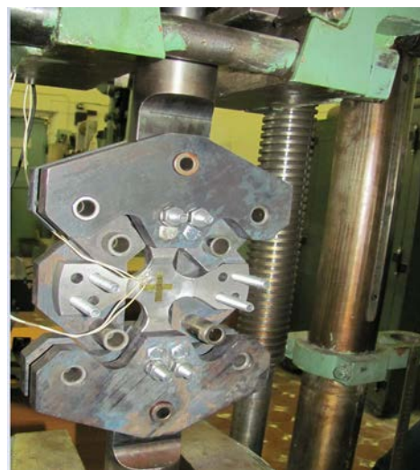
Рис. 2. Приспособления для двухосных испытаний: а – растяжение-сжатие; б – растяжение-растяжение
