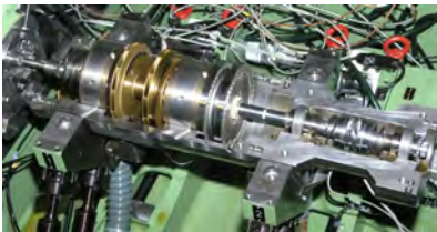
Рис. 9. Ротор в приспособлении на разгонно-балансирующем стенде
