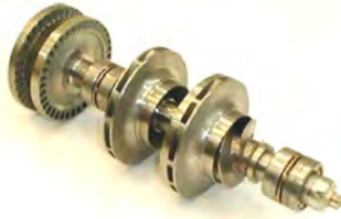
Рис. 5. Ротор ТНА водорода ЖРД РД-0146
