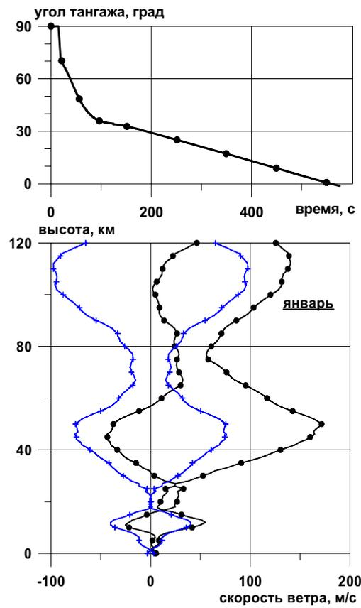
Рис. 2. Программа изменения угла тангажа РН и критические профили ветра, «наихудшие» для смещения точки падения ОЧ в плоскости ортодромии (—●—) и в ортогональной ей плоскости (—+—)
