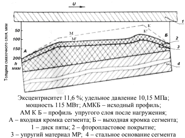
Рис. 14. Форма зазора в среднем окружном сечении наружного ЭМП сегмента гидроагрегата А-8 ВоГЭС им. В.И. Ленина ( p=10,15 МПа)
