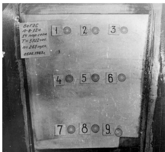
Рис. 16. Состояние поверхности трения после наработки 5722 часов ( p = 10,15 МПа)
