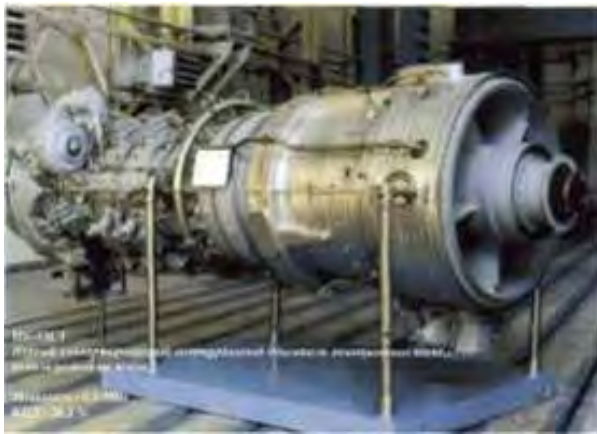
Рис. 1. Конвертированный газотурбинный авиационный двигатель НК-12СТ
