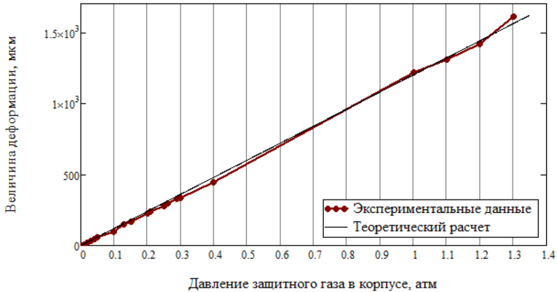
Рис. 5. Зависимости величины деформации крышки от давления защитного газа
