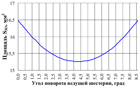
Рис. 7. График изменения площади запертого объема S_{30} в зависимости от углового положения шестерен
