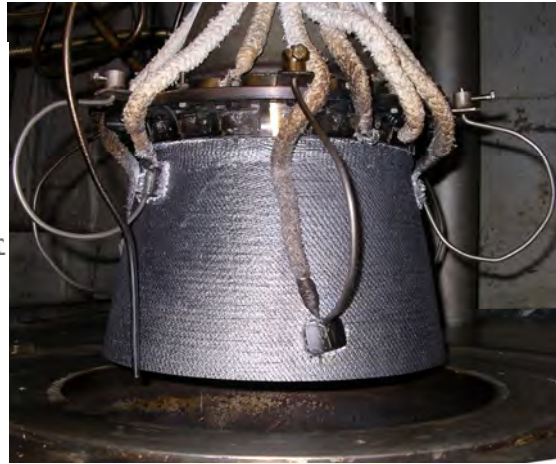
Рис. 9. Измерение поверхностной температуры насадка из УУКМ при помощи термостойких упругих элементов
