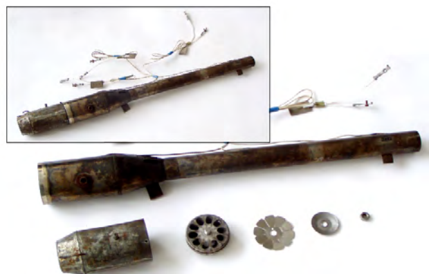
Рис. 3. Модельная прямоточная пульсирующая камера сгорания с соосным металлическим лепестковым клапаном
