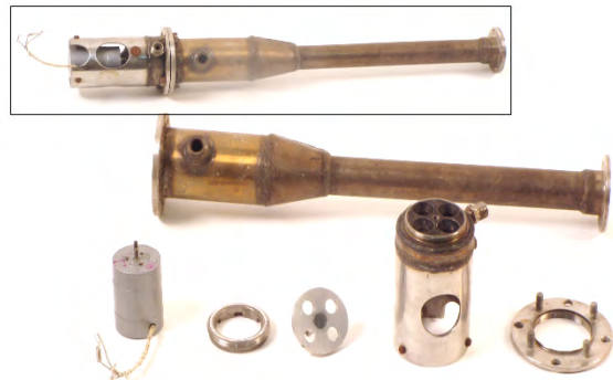
Рис. 2. Модельная прямоточная пульсирующая камера сгорания с вращающейся клапанной решёткой
