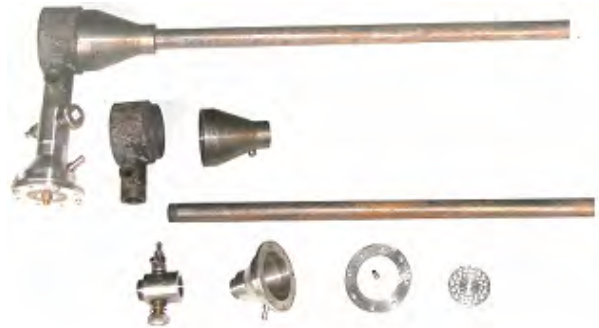
Рис. 5. Модельная прямооточная пульсирующая камера сгорания с перпендикулярным расположением механического неметаллического мембранного клапана
