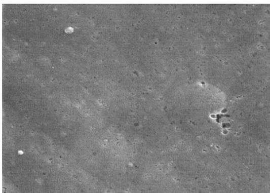
Рис. 5. Хромовое покрытие Cr(III) 15-20 мкм, полученное в электролите с наночастицами  $Al_2O_3$ , увеличение  $\times 500$
