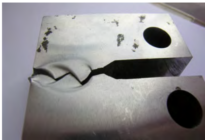
Рис. 4. Деформационный волновой процесс на поверхности излома
