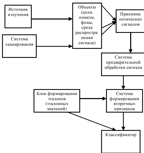
Рис. 1. Структурная схема лазерно-электронной системы дистанционного зондирования поверхности
