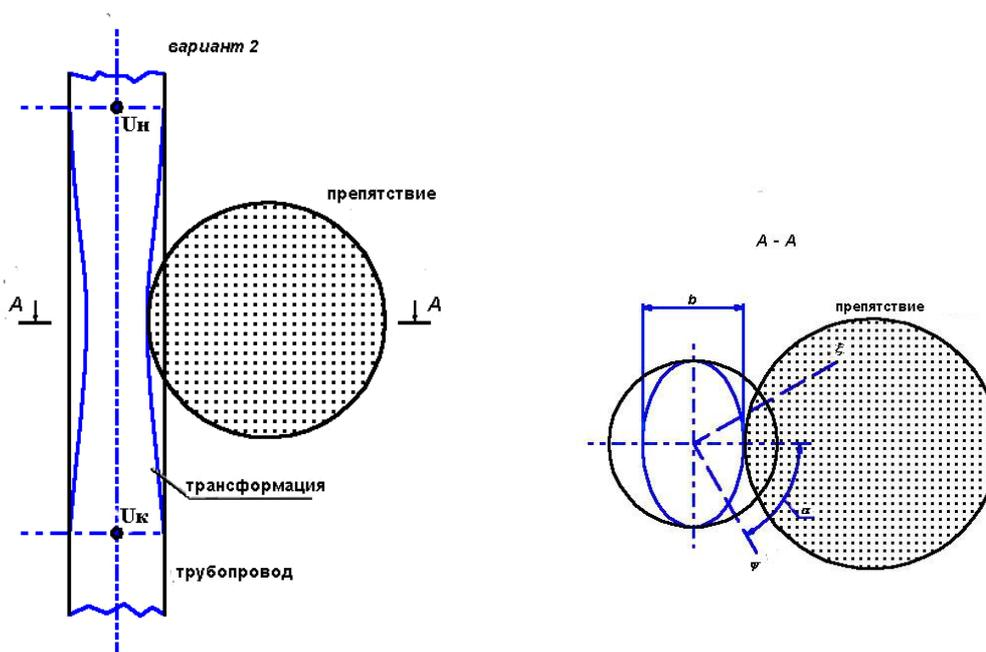
Рис. 2. Трансформация с изменением формы сечения трубопровода
