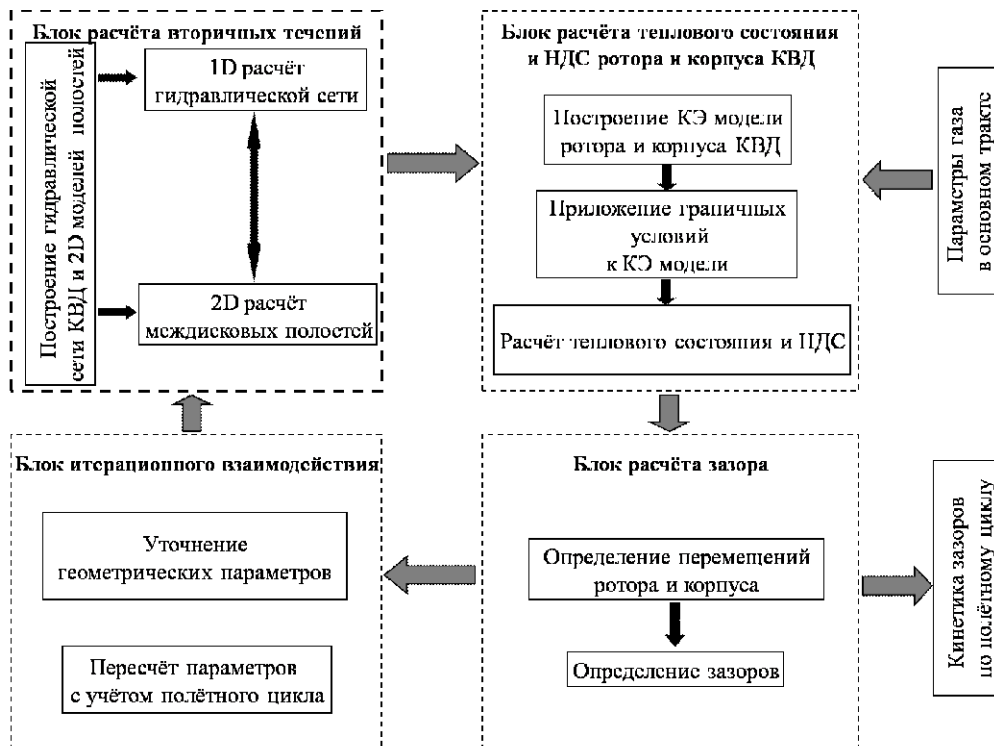
Рис. 1. Алгоритм расчёта кинетики радиальных зазоров
