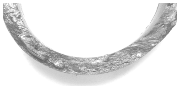
Рис. 9. Излом по месту разрушения вала № 1
