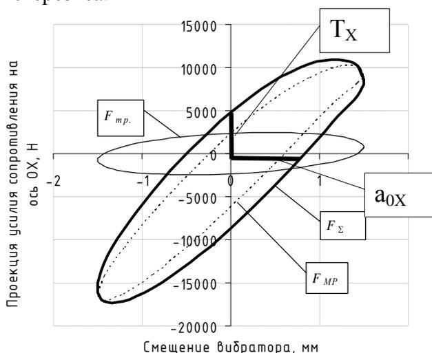
Рис. 2. Суммарный гистерезис и его составляющие в проекции на ось  $OX$
