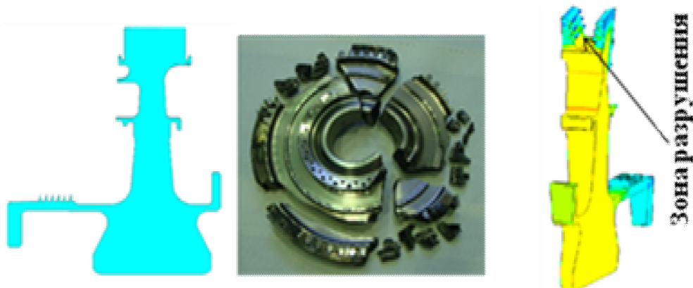
Рис.1. Меридиональное сечение, разрушенный диск и поле напряжений
