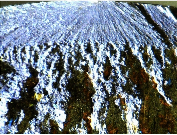
Рис. 1. Область излома стали 40XH, выполненного под углом 15^\circ к обработанной поверхности; увелич. \times 15
