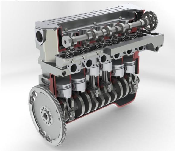
Рис. 1. Продольный разрез двигателя
