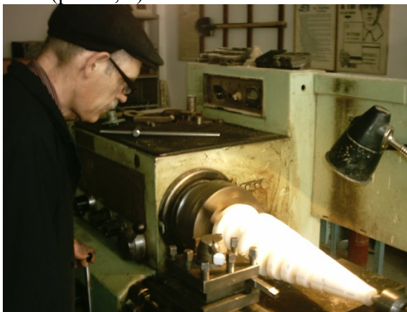
Рис. 1. Нарезка на коническом роторе винтовой поверхности на серийном токарном станке
