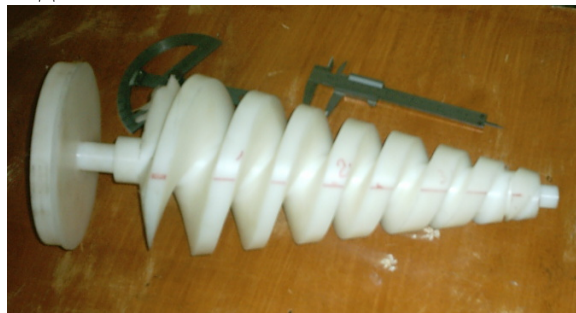
Рис. 2. Модель основного ротора винтовой расширительной машины. Диаметры 160 / 40 мм, угол конусности ротора 20^\circ , длина винтовой части 400 мм, винтовая поверхность в виде двухзаходной резьбы на четыре оборота с шагами 112, 96, 96 и 80 мм
