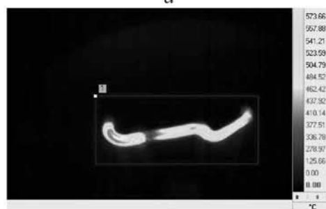
Рис. 5. Влияние сапфирового окна на измерение температуры
