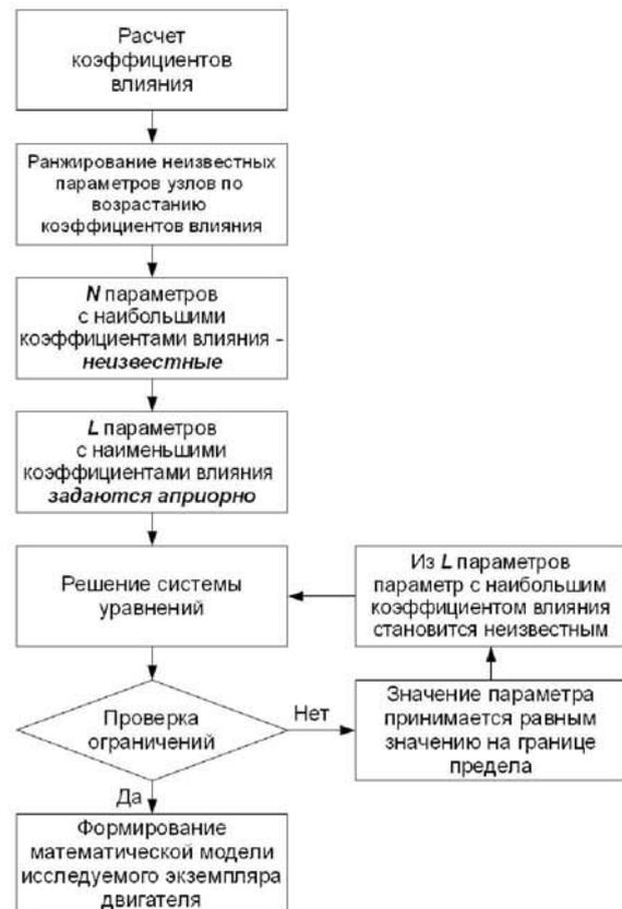
Рис. 3. Структура информационной подсистемы виртуальной лаборатории испытаний ГТД
