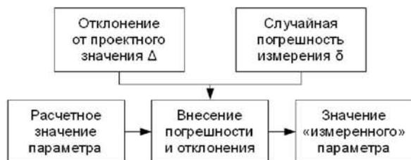
Рис. 2. Схема имитации погрешностей измерений и отклонений
