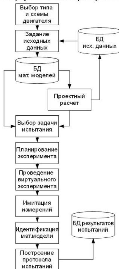
Рис. 5. Схема алгоритма работы виртуальной лаборатории испытаний ГТД
