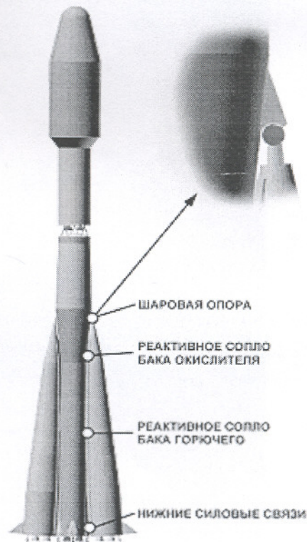
Рис. 1. Средства обеспечения отделения боковых блоков РН типа “Союз”
