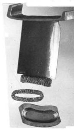
Демпфер ленточный / 1Х18Н9Т, толщина- 0,08/ Демпфер из МР с покрытием  $\text{MoS}_2+\text{Ф}_4$
