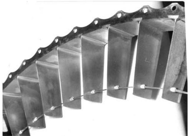
Рис. 10. Спрямяющий аппарат с демпферной связью
