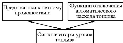
Рис. 5. Инфологическая модель базы данных для решения задачи «Отключение автоматического расхода топлива по магистралям двигателей левого борта объекта»
