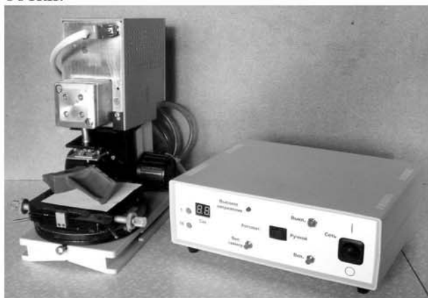
Рис.3. Установка РДУ «КРОС-2» для определения кристаллографической ориентировки монокристаллов
