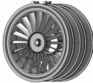
Рис. 17. 3D параметрическая модель направляющего аппарата
