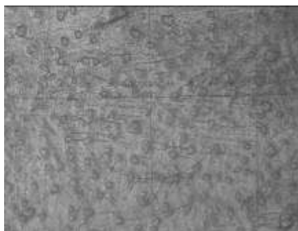
Рис. 3. Микроструктура сплава ХН65ВМТЮ после эксплуатации 62449 часов
