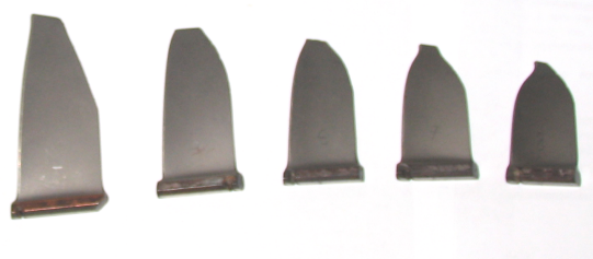
Рис. 3. Характер предельного износа рабочих лопаток ГСВ по ступеням со 4 по 8 слева направо (наработка 128 часов)
