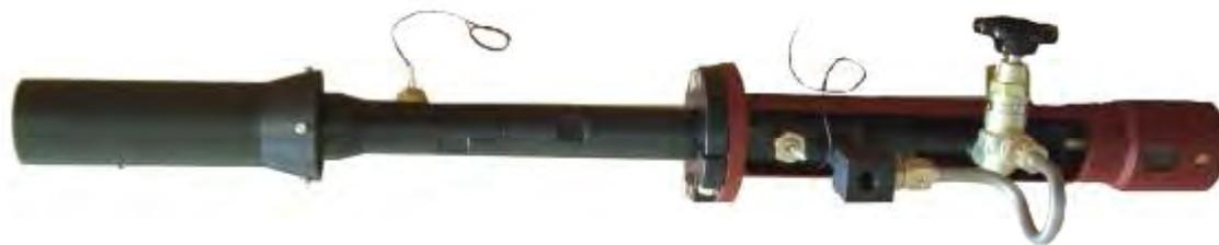
Рис. 1. Макетный образец ПДД малой тяги
