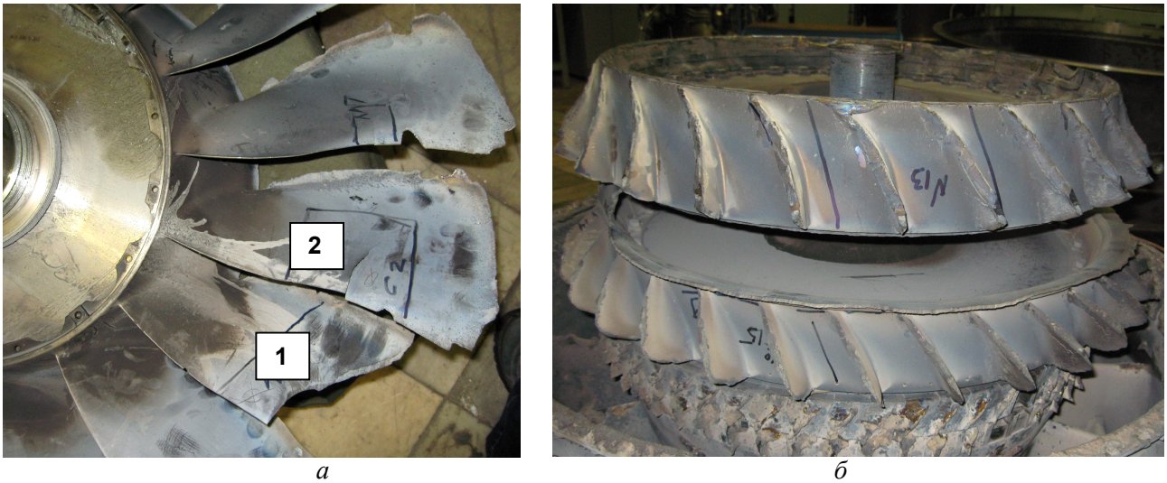
Рис.1. Фрагмент разрушенного ПК 1-й ступени вентилятора (а), рабочие лопатки 2-й и 3-й ступеней (б)
