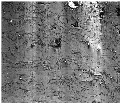
Рис. 2. Микроструктура интерметаллидного подслоя «NiCoCrAlY» (1000)
