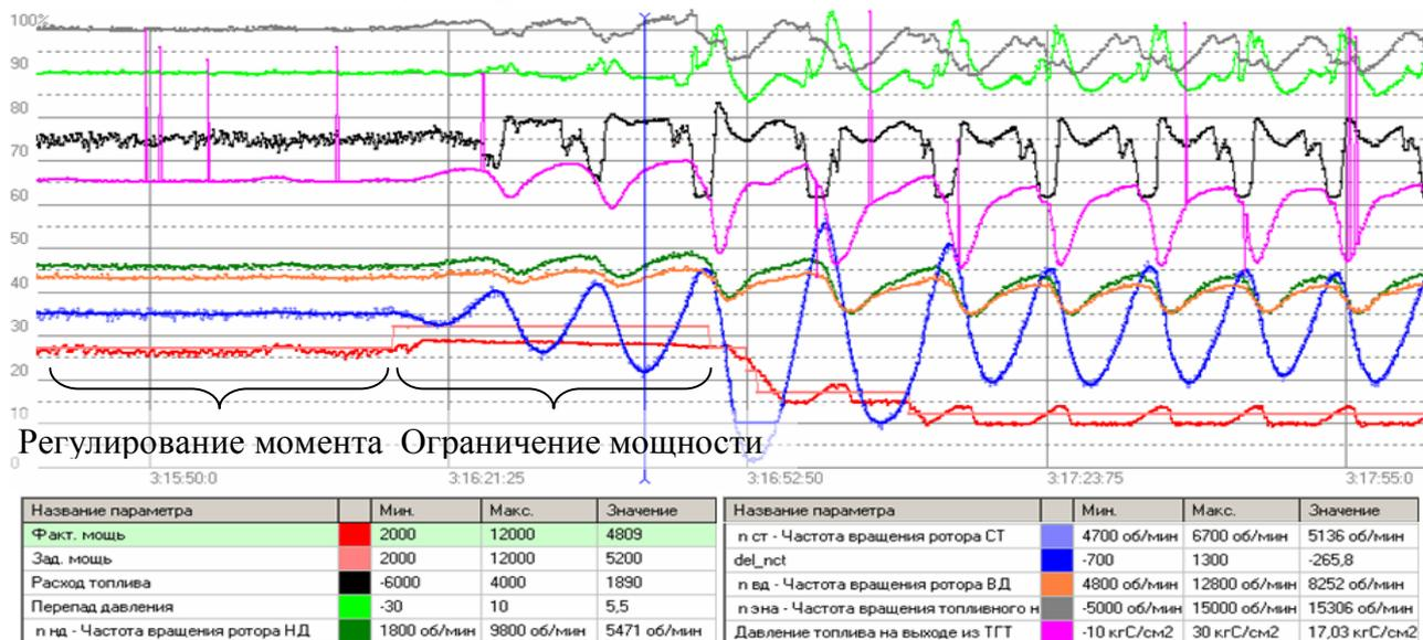
Рис. 19. Возникновение неустойчивости контура п<sub>СТ</sub> на  $N_{Г}= 4800$  кВт и автоколебания на  $N_{Г}= 3200$  кВт; ГТ1-001; Ходовые испытания; 20.12.2008 г.  $f=0,1$  Гц
