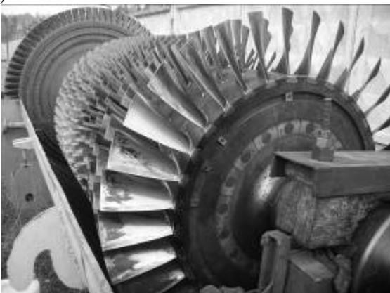
Рис. 1. Ротор осевого компрессора ГТК-25И с восстановленными лопатками после эксплуатации
