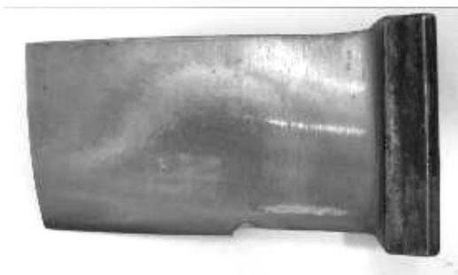
Рис. 3. Окисление нитридного покрытия на компрессорной лопатке после эксплуатации
