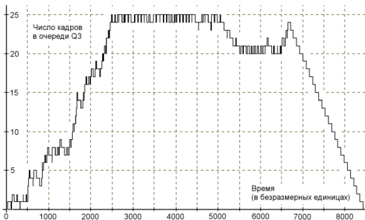
Рис. 4. Диаграмма состояния очереди выходного порта для модели без регулирования потока кадров
