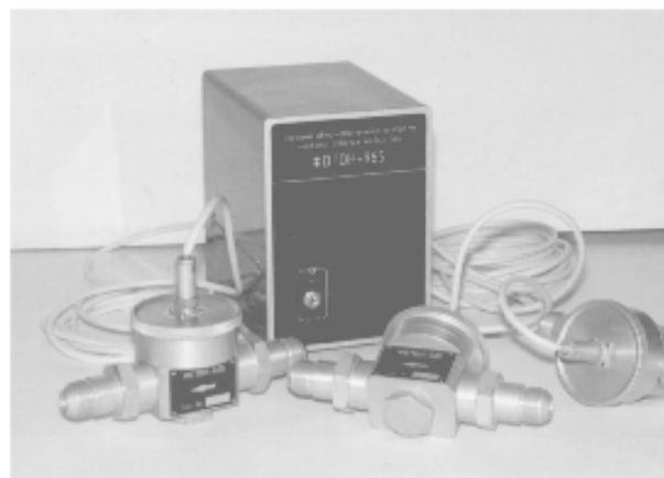
Рис. 3. Общий вид системы ФОТОН – 965 с датчиками встроенного контроля
