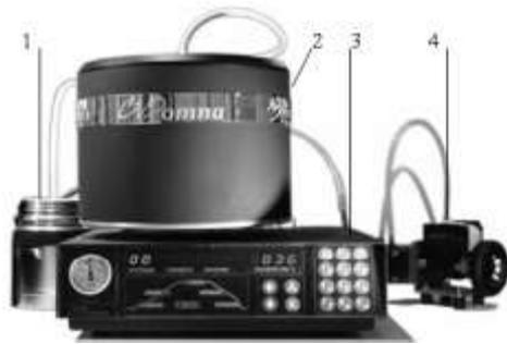
Рис. 5. Установка синтеза УНТ: 1-система подачи парогазовой смеси; 2-реактор; 3-блок управления и контроля; 4-система откачки
