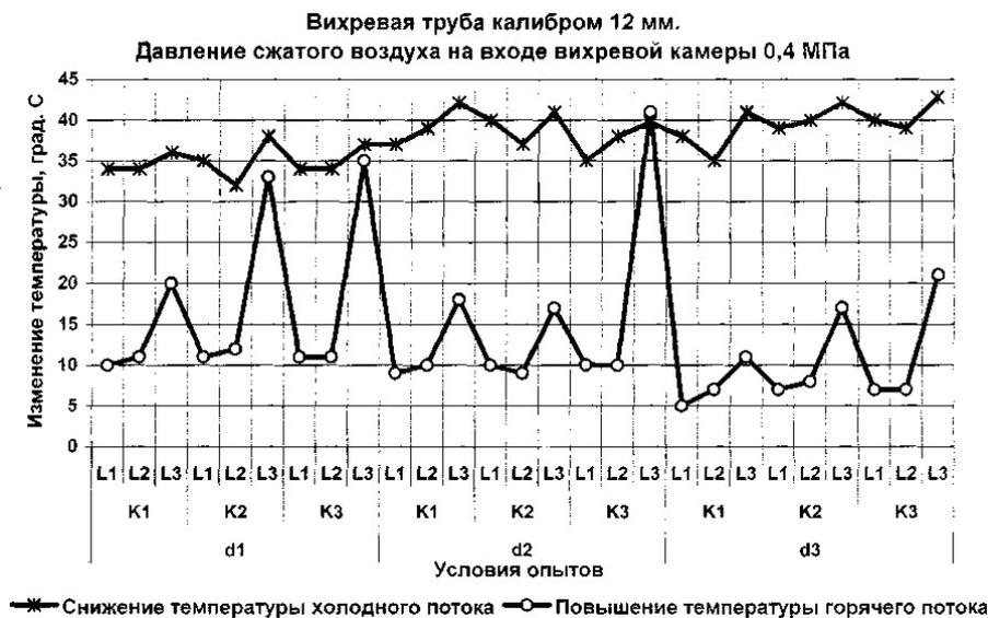
Рис. 2. Зависимость температурного разделения вихревых потоков от размеров элементов вихревой камеры
