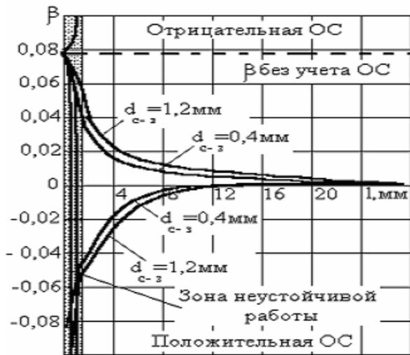
Рис. 8. Влияние дополнительной ОС по положению струйной трубки
