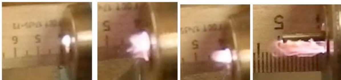
Рис. 14. Форма разряда при обдуве кольцевой области между крышкой и штыревым электродом воздухом при входных давлениях (слева направо): 20 кгс/см 2 , 10 кгс/см 2 , 2 кгс/см 2 , 2 кгс/см 2
