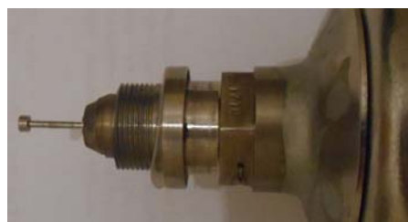
Рис. 12. Свеча агрегата зажигания КН-11Б со штыревым электродом
