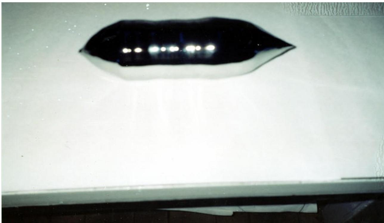
Рис. 5. Слиток германия диаметром 104 мм
