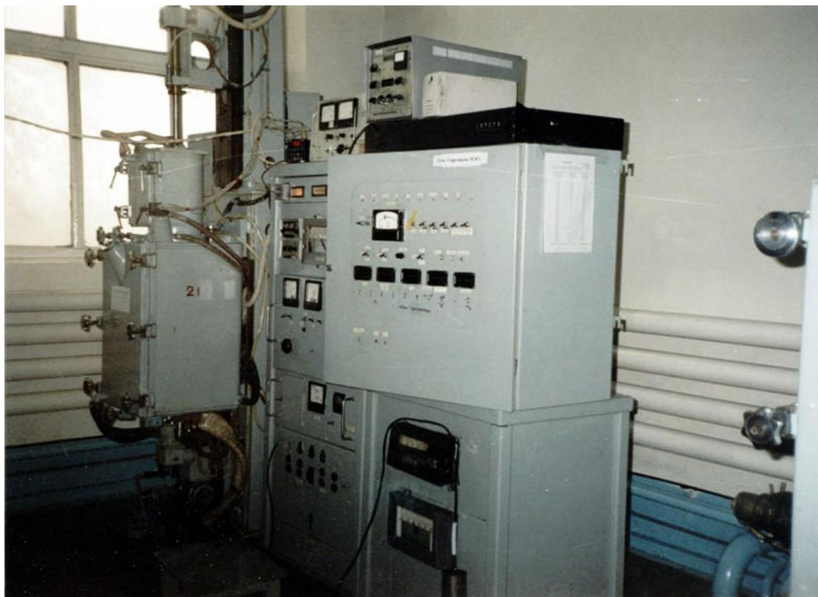
*Рис. 3. Микропроцессорная система управления вытягиванием монокристаллов германия*
