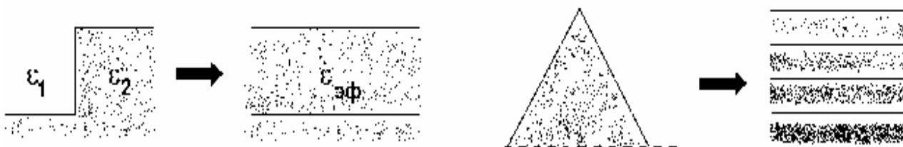
Рис. 1. Переход от бинарного и треугольного профиля антиотражающей решетки к тонкопленочному покрытию
