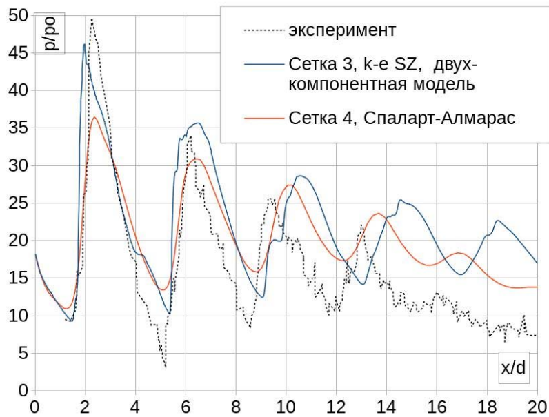
Рис. 7. Сравнение расчётного поля приведённого полного давления, полученного при использовании различных моделей турбулентности
