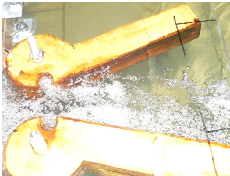
Рис. 4. Визуализация течения с ВЯ ( \alpha = 40^\circ )
