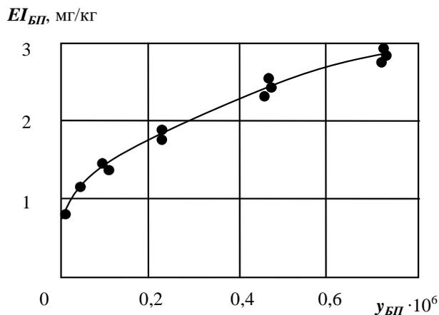
Рис. 2. Зависимость выхода БП от массового содержания БП ( $y_{БП}$ ) в смеси с изооктаном ( $a_0 = 0,5$ ;  $t_{II} = 10$  мс)
