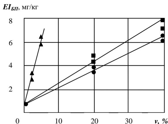
Рис. 1. Зависимость выхода БП от содержания ароматических углеводородов ( $v$ ) в смеси с изооктаном ( $a_0 = 0,5$ ;  $t_{II} = 10$  мс):
