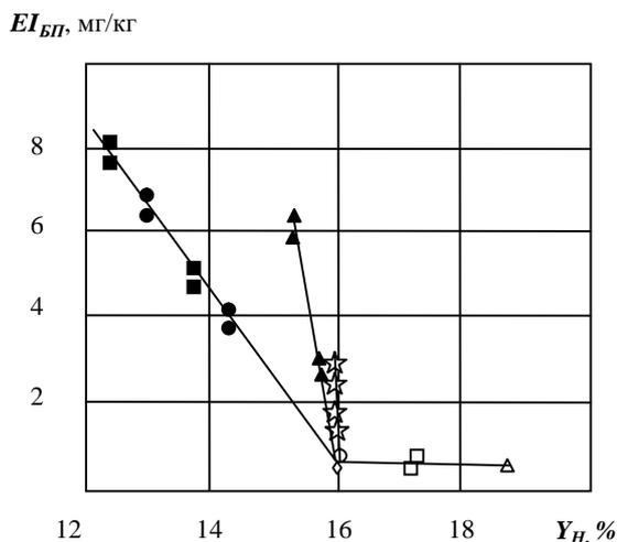
Рис. 3. Зависимость массового выхода БП от содержания водорода в топливе ( $Y_H$ ) ( $a_0 = 0,5$ ;  $t_{II} = 10$  мс):
