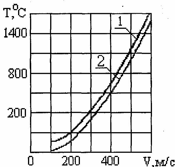
Рис. 3. Графики теоретической (1) и экспериментальной (2) температуры газового потока
