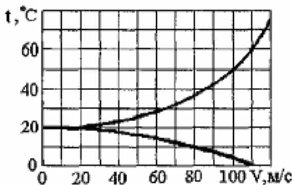
Рис. 2. График зависимости температурного разделения газовой струи от скорости истечения
