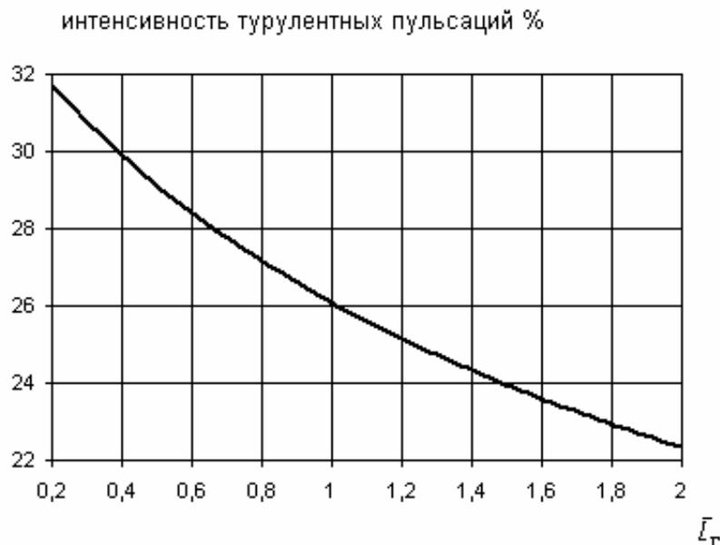
Рис. 3. Влияние на интенсивность турбулентных пульсаций длины газосборника жаровой трубы камеры сгорания
