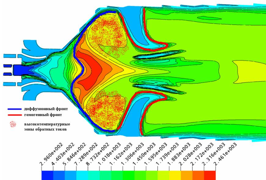
Рис. 1. Схематическое расположение фронтов пламени внутри двухзонной камеры сгорания ГТД
