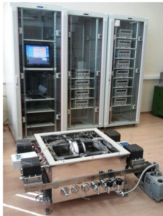
Рис. 2. Установка УИСЧ40 – вид без крышки с установленным силовым гироскопом
